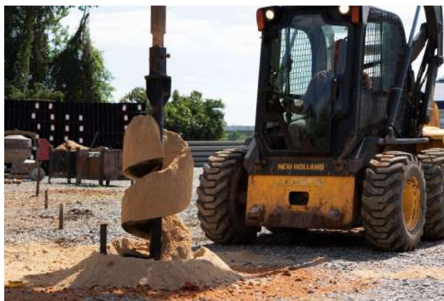
Furação com trado motorizado
